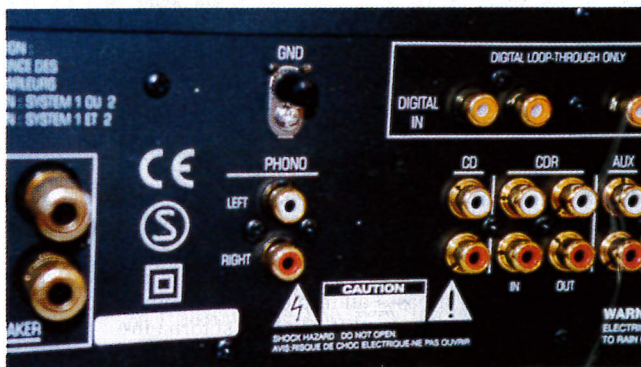
Particolare delle connessioni sul pannello posteriore. Notare la presenza dell'ingresso "Phono".
